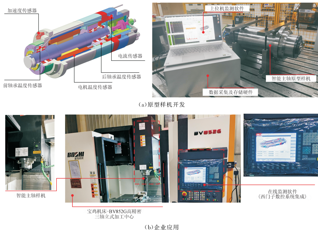
图 10 实现运行状态在线监测与评估的智能主轴
